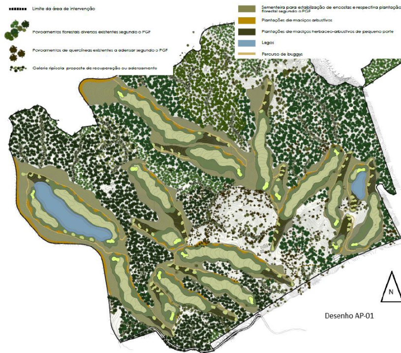
Figura 4 – Desenho AP-01 Projeto de Execução de Integração Paisagística. Apesar de a legenda referir nas envolventes do campo “Sementeira para estabilização de encostas e respetiva plantação florestal segundo o PGF” as únicas plantações de árvores referidas nos outros desenhos são junto dos caminhos de buggy e espécies não florestais. Assim a legenda para além de confusa não é consistente com o PGF que só prevê plantação nos espaços tipo I e linhas de água (imagem extraída do parecer do ICNF, I.P., vertido no parecer da CA – fator biodiversidade).
