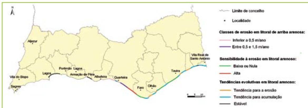
Figura 2.4.2 - Erosão em litoral de arriba arenosa e sensibilidade à erosão e tendência evolutiva em litoral arenoso. Fonte: CCDR Algarve, ICN (1998)<sup>(16)</sup>, Pinto (2004)<sup>(16)</sup>, Pinto & Teixeira (2003)<sup>(17)</sup>
